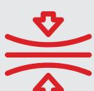
Las planchas alveolares Klar pueden curvarse en frío en dirección longitudinal, con radios de curvatura que varían entre 750 y 1500 mm, según su espesor.
