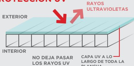
Las planchas alveolares Klar incorporan una capa coextruida de protección UV, aplicada de forma uniforme en toda la superficie y con el porcentaje óptimo para evitar el amarillamiento y la pérdida de luminosidad con el tiempo.
